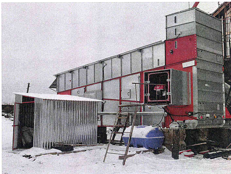
Рисунок 1. Зерносушилка конвейерная, торговая марка «АТМ», модель АТМ UNIVERSAL-12 (общий вид).
