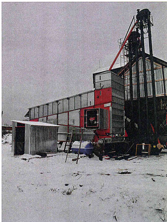
Рисунок 2. Зерносушилка конвейерная, торговая марка «АТМ», модель АТМ UNIVERSAL-12 в составе технологической линии (в работе).
