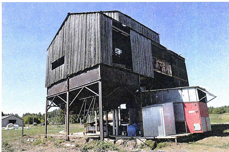
Рисунок 2. Зерносушилка конвейерная, торговая марка «АТМ», модель АТМ UNIVERSAL-9 в составе технологической линии (в работе).
