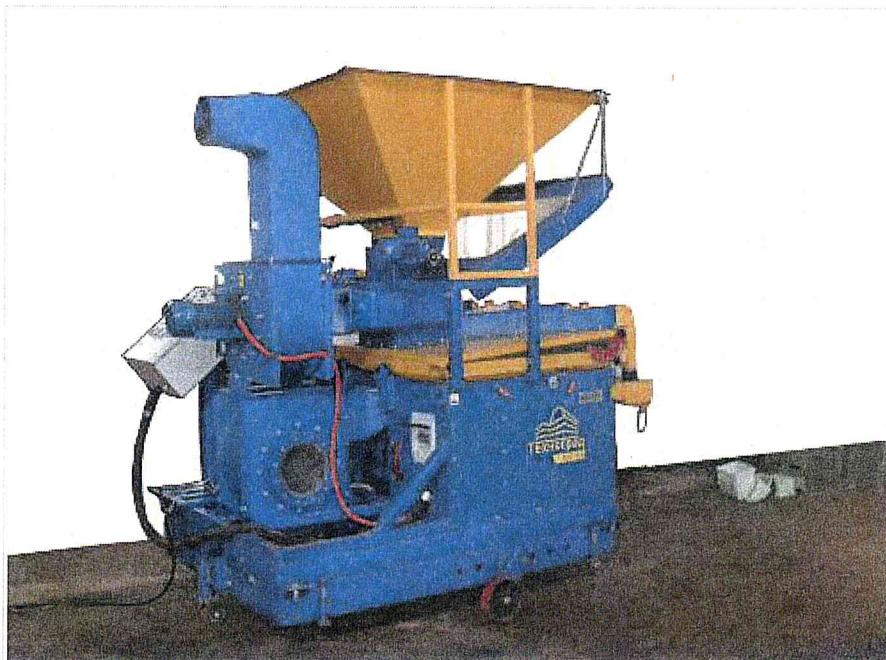
Рисунок 1. Стол вибропневмосортировальный марки ВПС, тип ВПС-5,0 (общий вид спереди).
