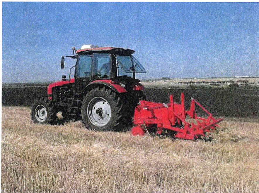
Рисунок 2. Глубокорыхлитель КАМА TIGER 2,5 в агрегате с трактором Беларус 1523 (в работе).
