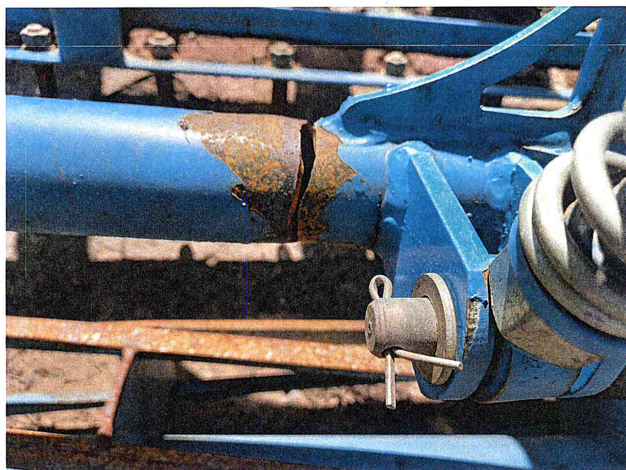
Рисунок 3 – Трещина рамы катка.
