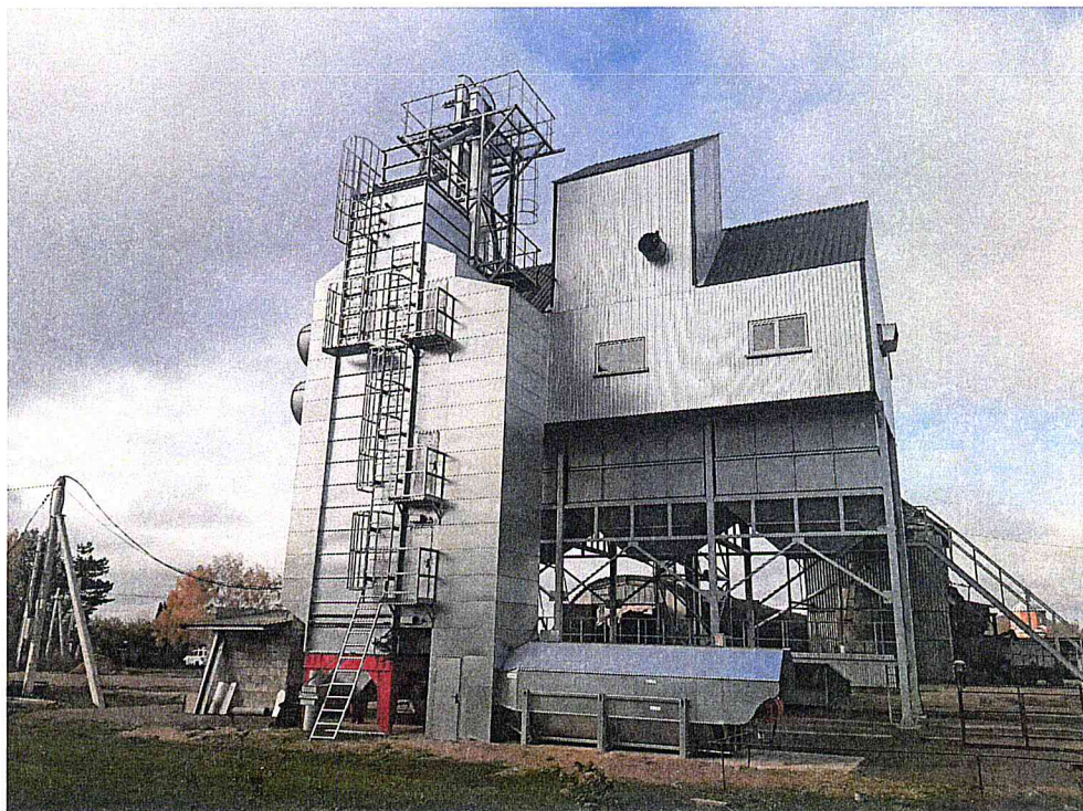
Рисунок 2. Зерносушилка модульная шахтная марки VENTUM, модель VENTUM-25 в работе в составе технологической линии.
