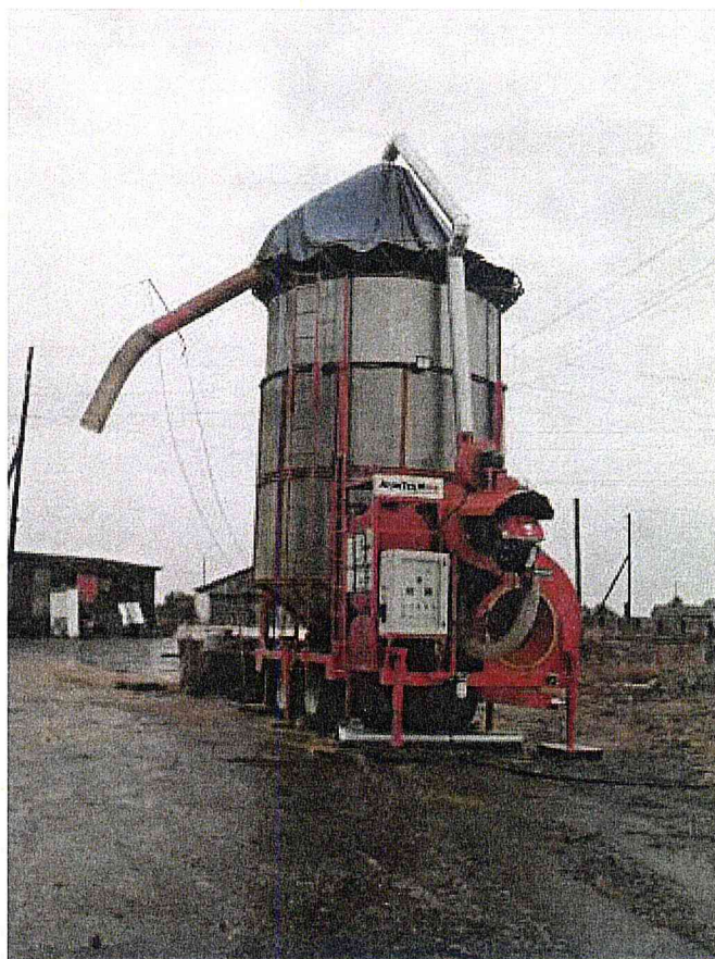
Рисунок 1. Зерносушилка, торговая марка «АТМ», модель АТМ SMART-20 (общий вид).
