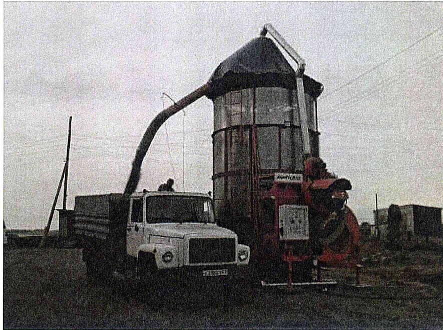
Рисунок 2. Зерносушилка, торговая марка «АТМ», модель АТМ SMART-20 в работе на выгрузке зерна.
