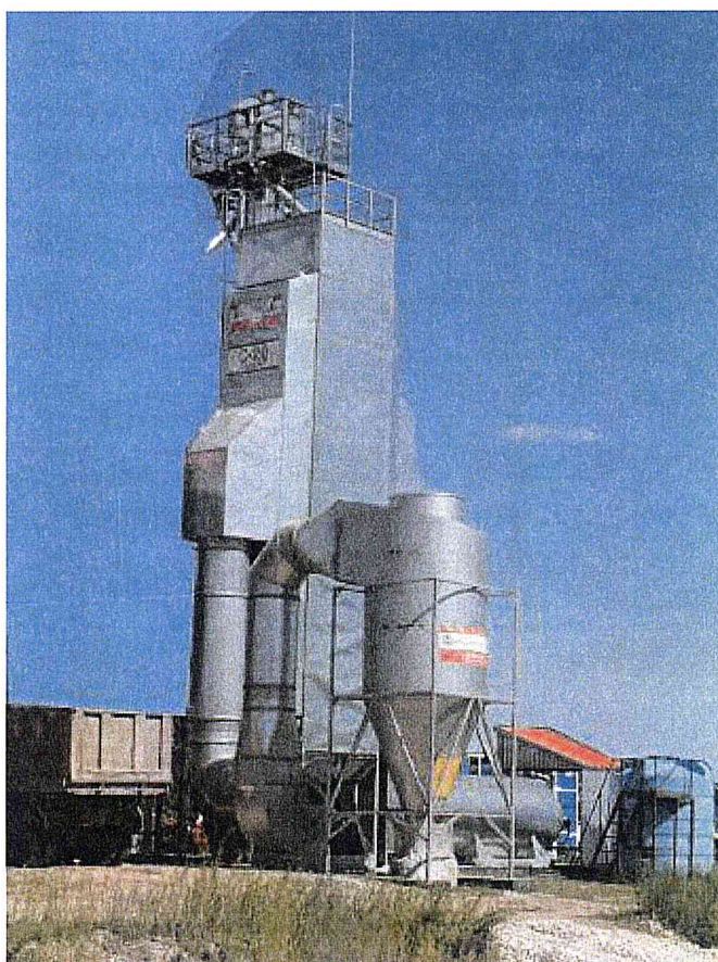
Рисунок 1. Сушилка зерновая шахтная модульная типа «С» С-20 «Стандарт» с косвенным типом нагрева, вид топлива: дизельное (общий вид).
