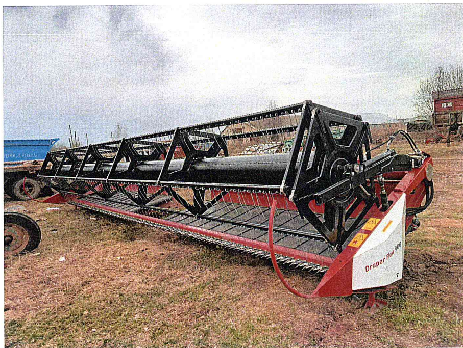
Рисунок 1 – Косилка валковая транспортерная КВТ 9-18 «Draper Flow 900» (общий вид спереди).
