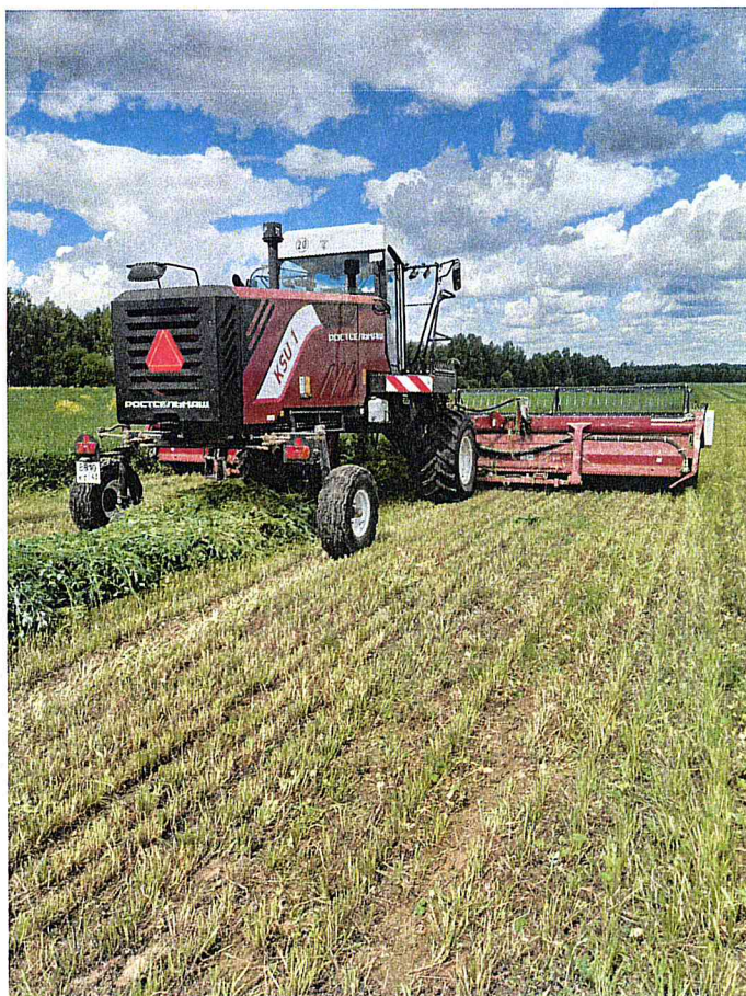
Рисунок 2 – Косилка валковая транспортерная КВТ 9-18 «Draper Flow 900» (в работе).
