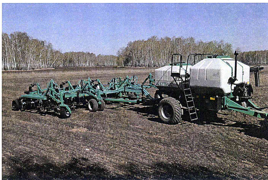
Рисунок 1 – Посевной комплекс «Кузбасс» ПК-8,5 (общий вид).
