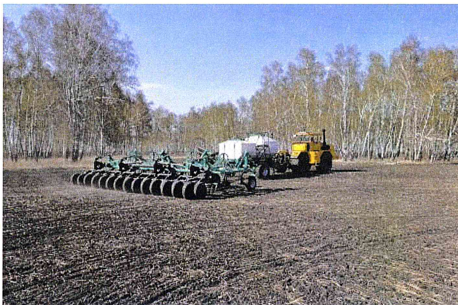
Рисунок 2 – Посевной комплекс «Кузбасс» ПК-8,5 в агрегате с трактором К-700 в работе.
