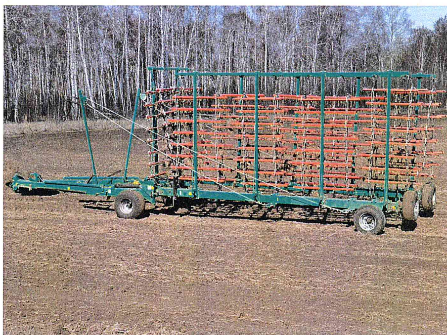
Рисунок 1 – Борона гидрофицированная универсальная БГУ-16-Ш «Кузбасс» (вид сбоку).
