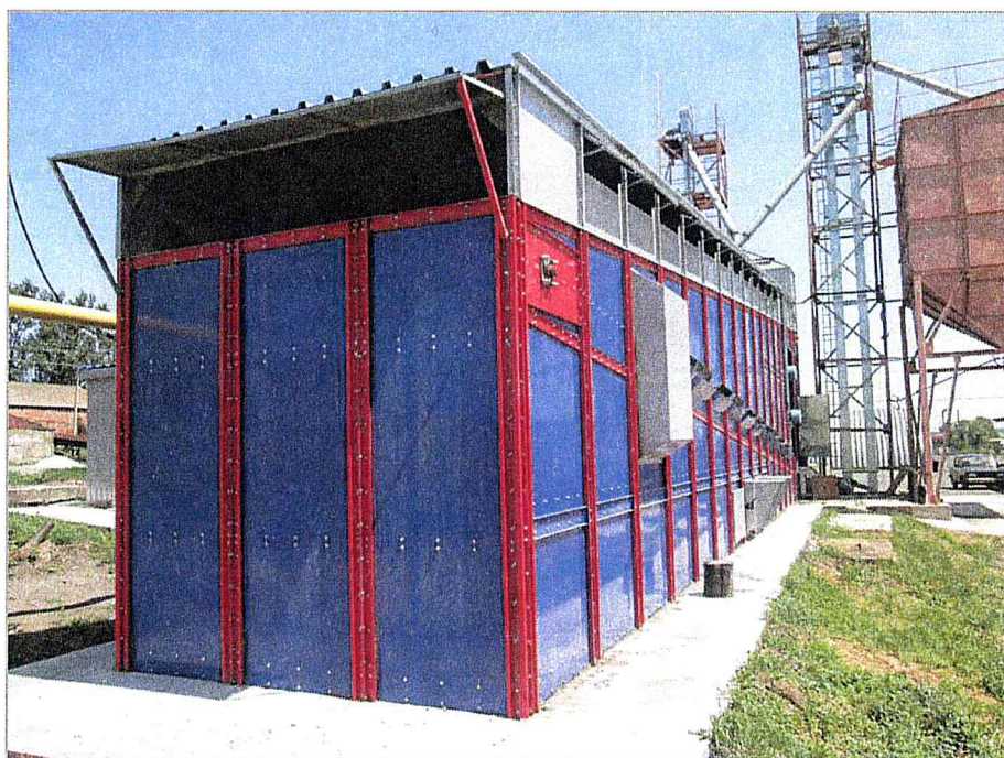
Рисунок 1. Зерносушилка конвейерного типа Motum-40 (общий вид).
