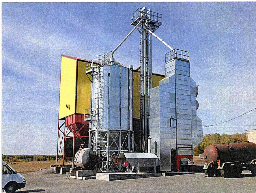
Рисунок 2 – Зерносушилка модульная шахтная VENTUM-15 в работе в составе технологической линии.
