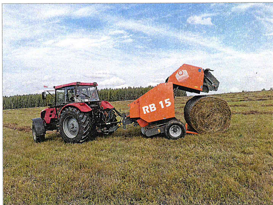
Рисунок 2 – Пресс-подборщик RB15NW в работе.
