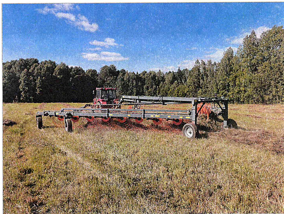
Рисунок 2 – Грабли колесно-пальцевые прицепные МК16С в работе.
