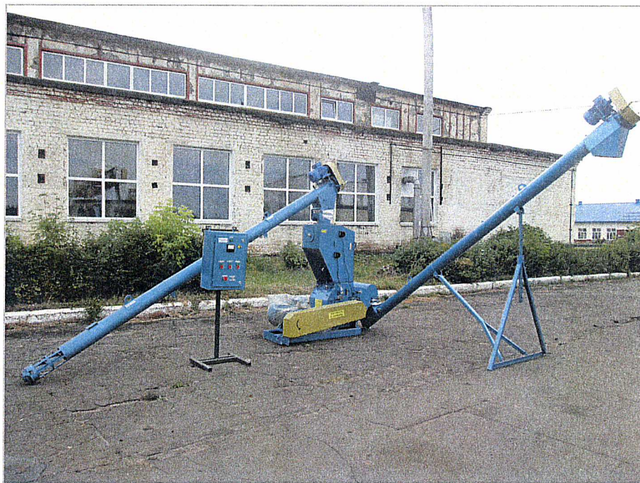
Рисунок 1 – Дробилка молотковая ДМ-4-1.
