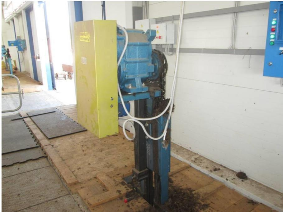
**Станция приводная вертикальная транспортёра
