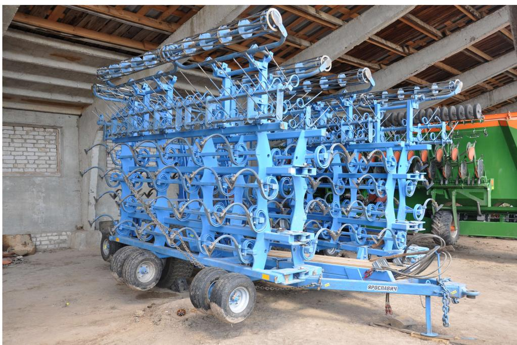
**Культиватор блочно-модульный КБМ-15ПСВ**
