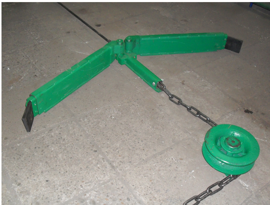
Установка навозоуборочная скреперная УНС-1
