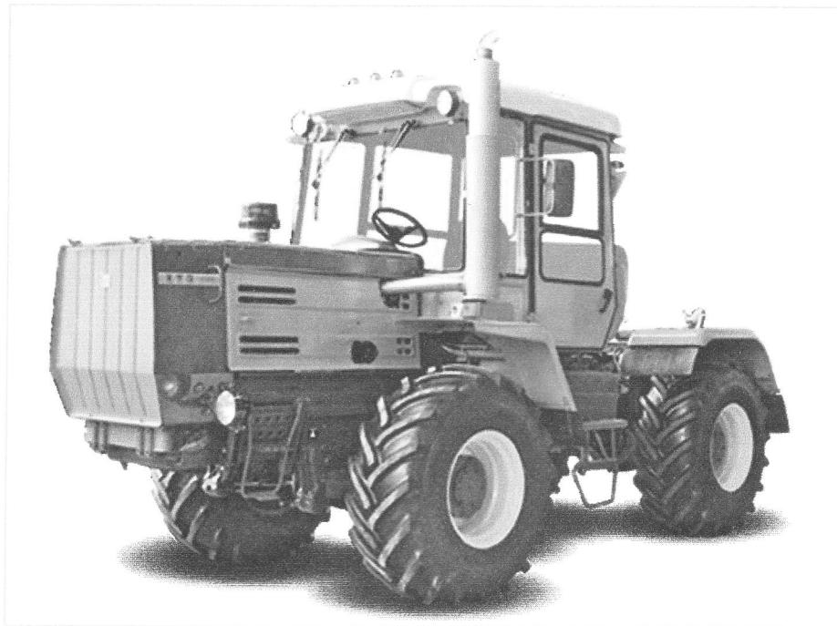
Рисунок 1 – Колесный трактор ХТЗ-150К-09-25.
