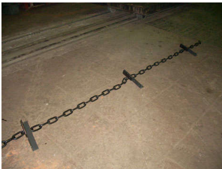
Рисунок 2 – Цепь со скребками транспортера горизонтального ТСН-160.
