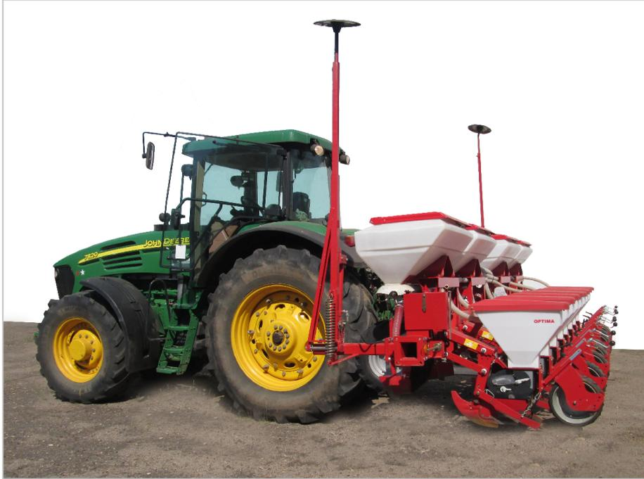
Рисунок 2 – Пневматическая сеялка точного высева Kverneland Optima Stand. Row в транспортном положении.
