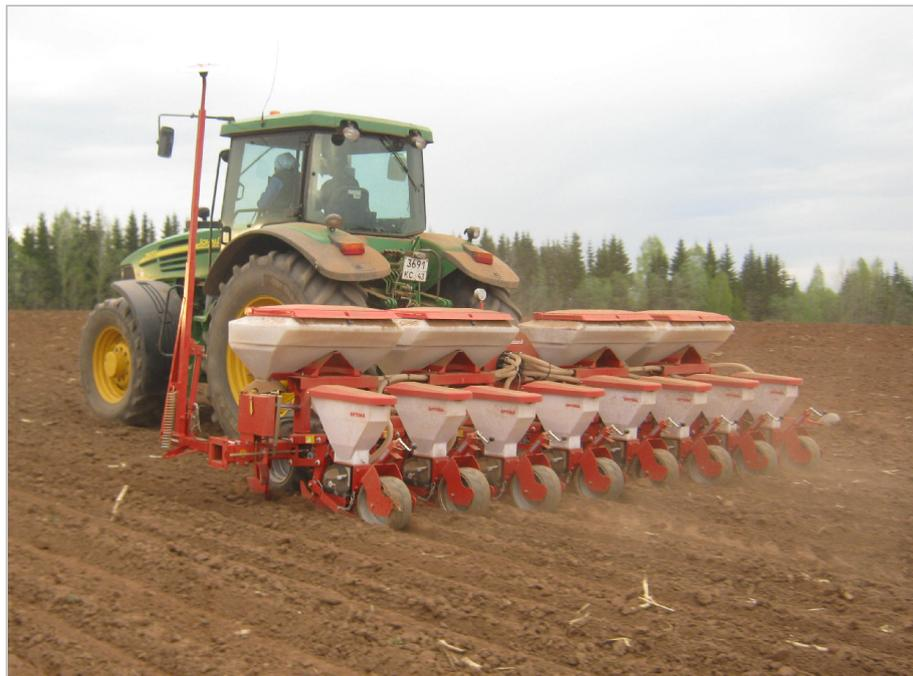
Рисунок 3 – Пневматическая сеялка точного высева Kverneland Optima Stand. Row в агрегате с трактором John Deere 7820 в работе.
