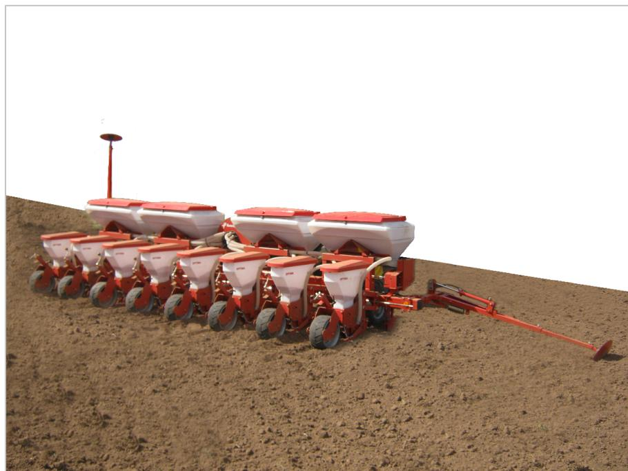
Рисунок 1 – Пневматическая сеялка точного высева Kverneland Optima Stand. Row (вид сзади справа).
