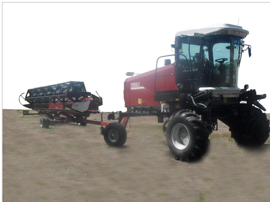
Рисунок 2 – Шасси самоходное ШС-150 (энергосредство) с транспортной тележкой РСМ-142.29 и уложенной на ней жаткой КВТ 9-18.
