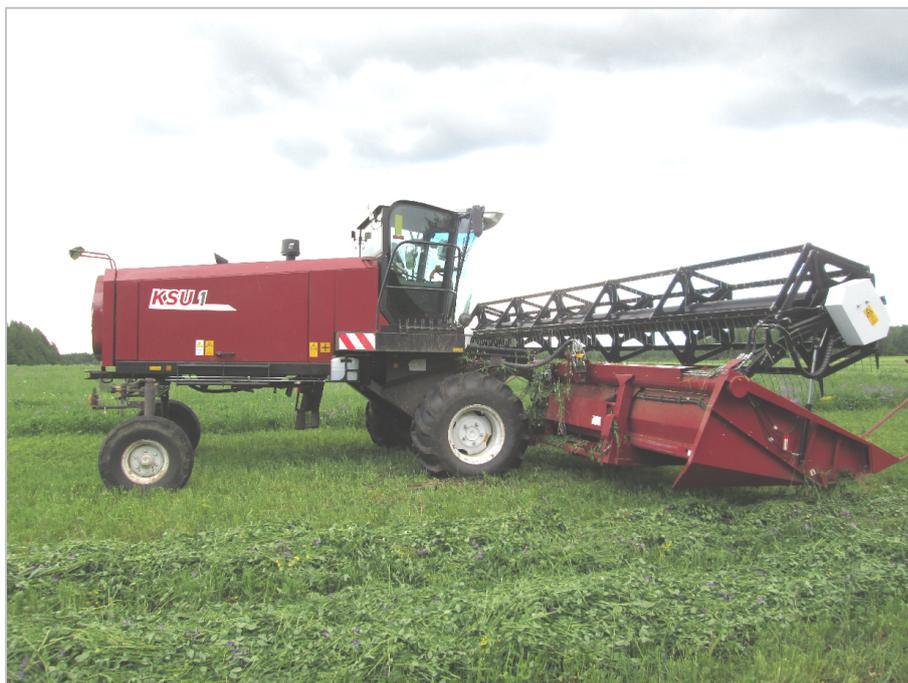
Рисунок 1 – Косилка КСУ-1 с жаткой КВТ 9-18 в рабочем положении.
