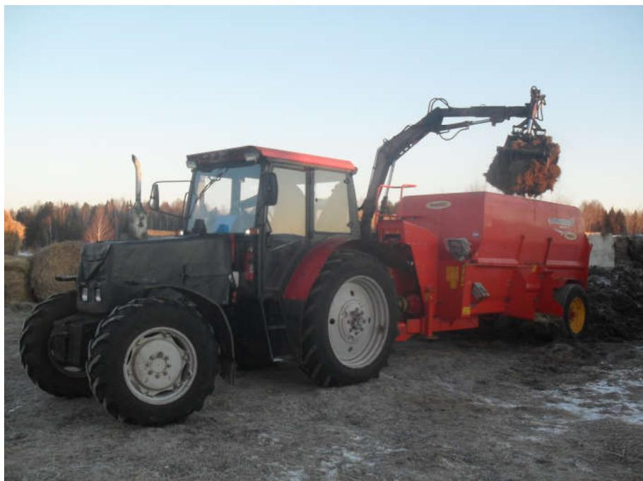
Рисунок 2 – Измельчитель-кормораздатчик SAMURAI 5 450/90 на погрузке силосной массы.
