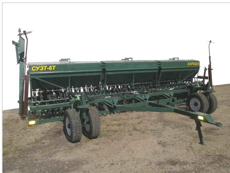
Рисунок 1 - Сеялка универсальная зернотукотравяная СУЗТ-6Т.
