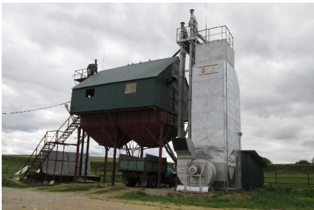
Рисунок 1 – Сушилка зерновая модульного типа «С» С-15
