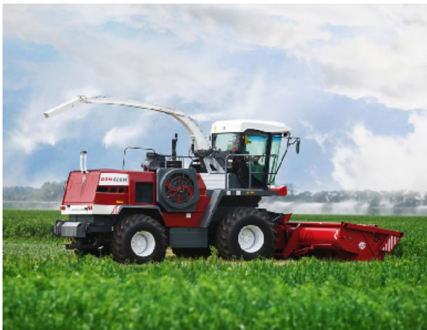
Рисунок 1 – Комбайн самоходный кормоуборочный РСМ-100 «ДОН-680М».
