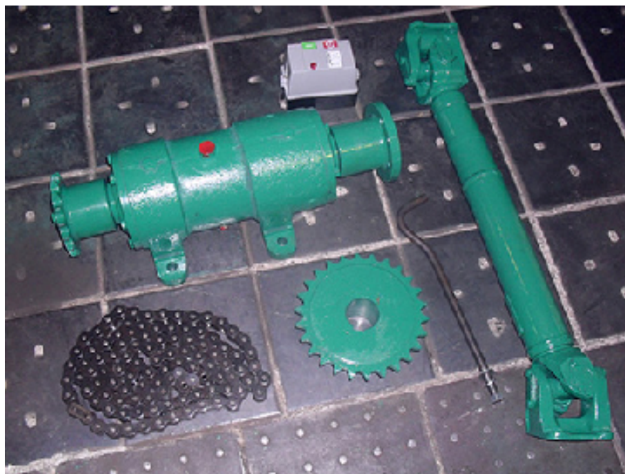
Сборочные единицы транспортера ТШН-250: карданный вал; приводная цепь; подшипниковая опора; звездочка привода; магнитный пускатель
