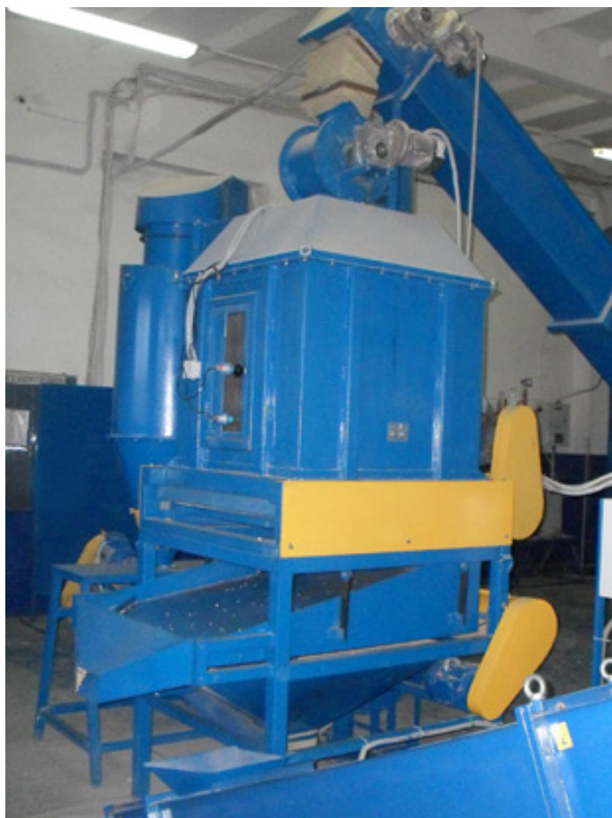
Колонна охлаждения ОКТ-1,5
